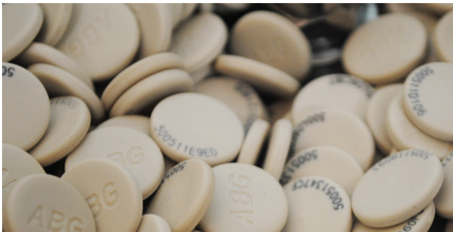
Figure 13 : Puces RFID : cette technologie permet par lecture du béton, frais à réception ou durci, de recueillir et localiser les informations souhaitées sur le matériau
